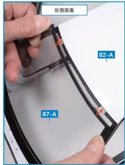
將 87-A 上側的小卡榫，從 82-A ○圍繞的缺口位置插入內側。這時，87-A 的上側可以輕輕地稍微彎曲，以便安裝。
