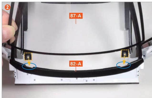
將 87-A 下側的螺絲孔卡榫從 82-A 圍繞的缺口位置插入內側。
