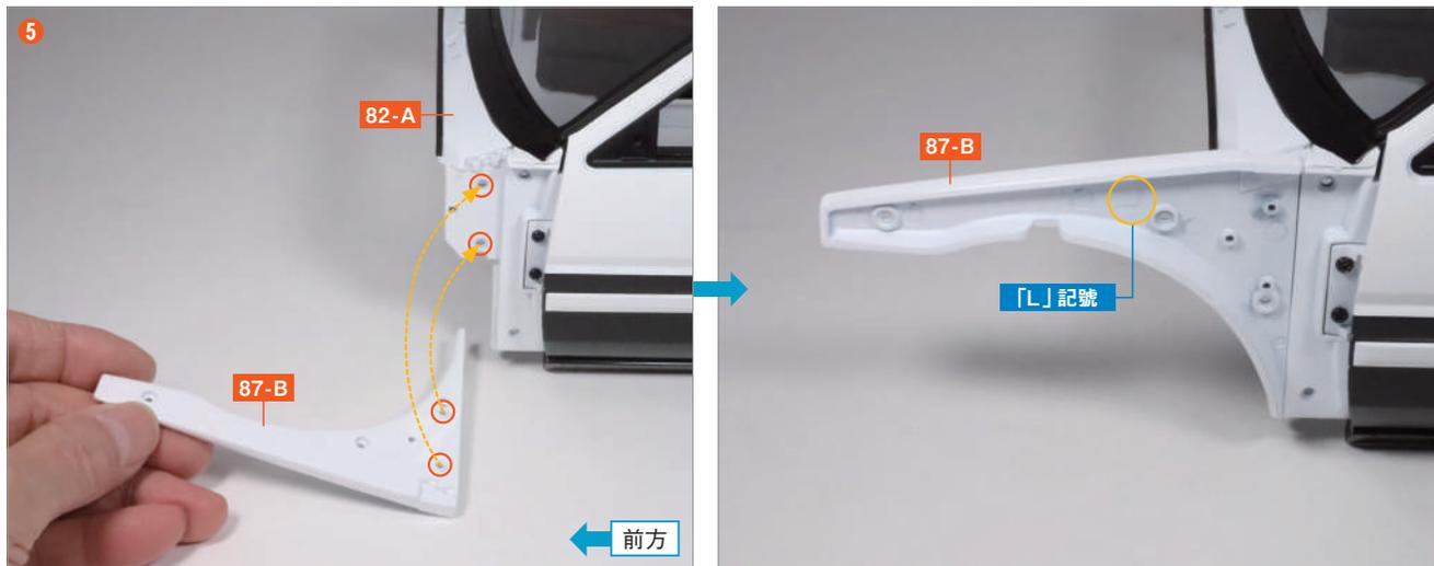
將前擋泥板支架 (L) 87-B 的兩個螺絲孔突起，對準 82-A 前方左側的兩個凹槽，然後插入安裝。
