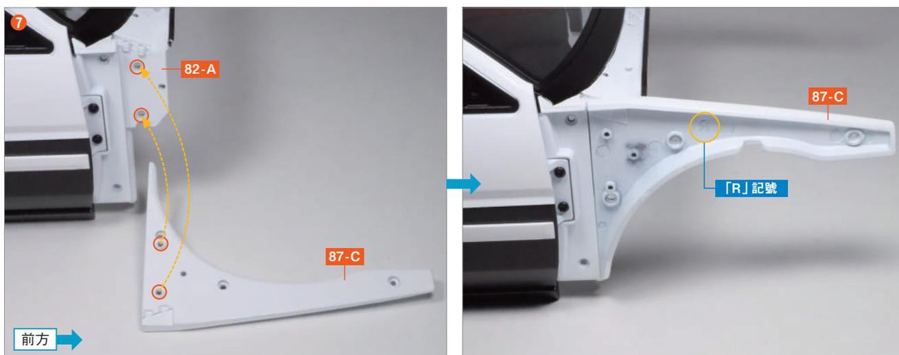
將前擋泥板支架 (R) 87-C 的兩個螺絲孔突起，對準 82-A 前方右側的兩個凹槽，然後插入安裝。
